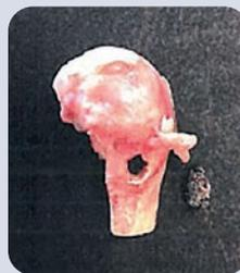
Risultato del test di push-out dei cilindri ricoperti da porous coating.
