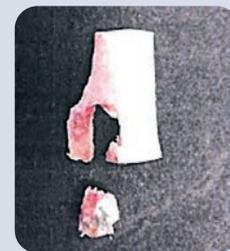
Risultato del test di push-out dei cilindri in Ti-Por<sup>®</sup>. L'osso risulta fratturato attorno all'impianto.
