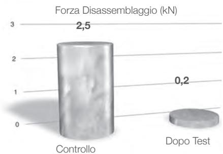
La forza richiesta per disassemblare il collo è diminuita di 10 volte dopo il completamento del test.
